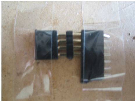
Slika 11: Odrezani letvici, pripravljeni za spajkanje.
